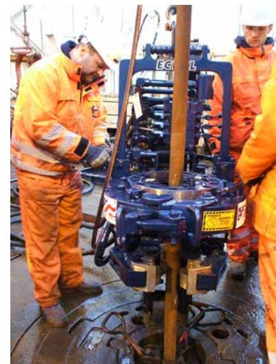
Трубный ключ Eckel 4-1/2 UHT (со сверхвысоким крутящим моментом) с встроенным стопорным устройством Tri-Grip, эксплуатирующийся на шельфе у берегов Польши в Балтийском море.
