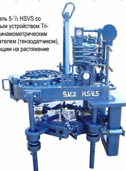
Вид сзади на стопорное устройство Tri-Grip с динамометрическим преобразователем (тензодатчиком), работающим на растяжение
