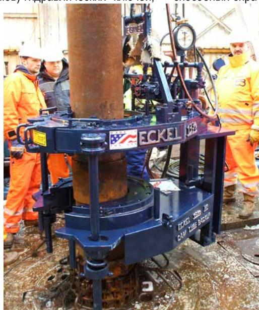
Стандартный трубный ключ 13-3/8 с встроенным стопорным устройством кулачкового типа, эксплуатирующийся на шельфе у берегов Польши в Балтийском море
