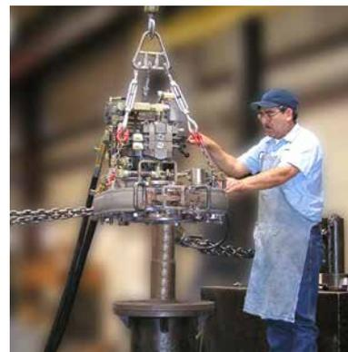
Определение крутящего момента трубного ключа Eckel
