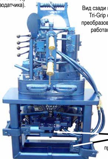
Точки крепления динамометрического преобразователя (тензодатчика), работающего на растяжение
