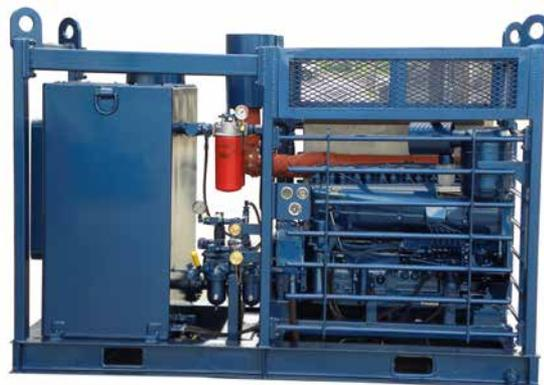
**Полноразмерная рама Eскеl - 4-точечная схема подъёма**
