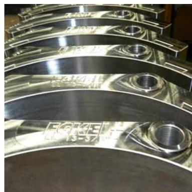
Обработанные на станках с ЧПУ типа CNC шарнирные головки от компании Eckel
